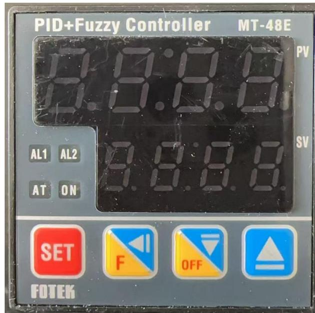
按 SET 后数字闪动，按上下加减温度，按左箭头可以移动到十位，百位上。设置到需要的温度后按 SET 件保存。温度范围 0-400 度，热熔温度根据面板的材料设置，一般为 100 度左右，视热熔后的效果加减温度来达到满意的效果，
